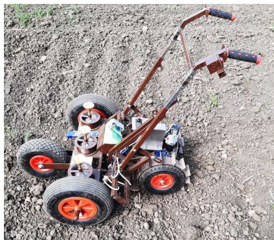
Рисунок 2 – Экспериментальный образец ручной селекционной сеялки для посева мелкосемянных культур
