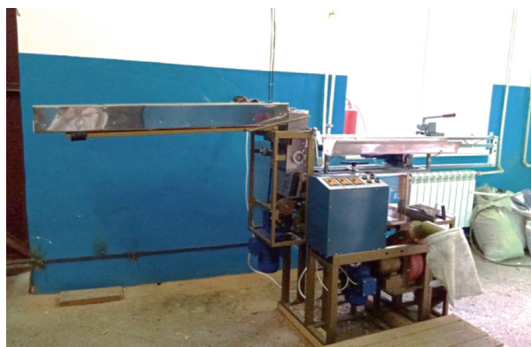
Рисунок 2 – Общий вид селекционной молотилки для обмолота отдельных растений сои МРС-1
