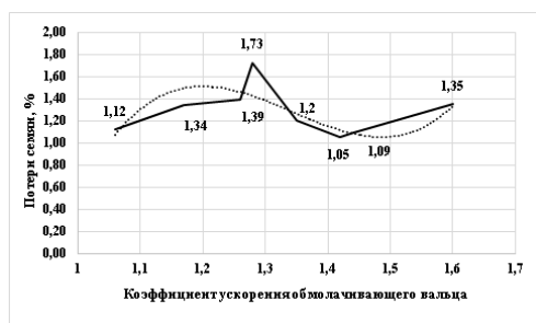
Рисунок 7 – Потери семян при обмолоте корзинок подсолнечника в зависимости от коэффициента ускорения обмолачивающего вальца
