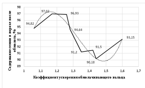
Рисунок 5 – График зависимости содержания семян в ворохе от коэффициента ускорения обмолачивающего вальца после обмолота корзинок подсолнечника
