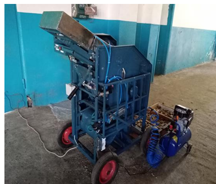
Рисунок 4 – Модернизированная молотилка для индивидуальных корзинок подсолнечника МКП-3М
